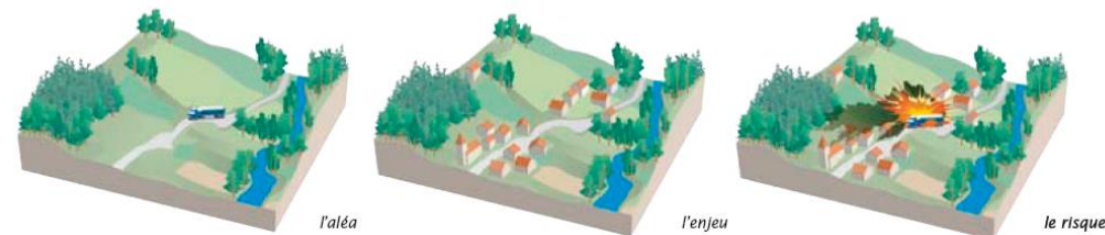
Schéma de l'aléa, de l'enjeu et du risque d'un accident de TMD
